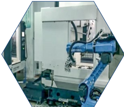
JR 系列机器人配合导轨于加工中心上下料应用
